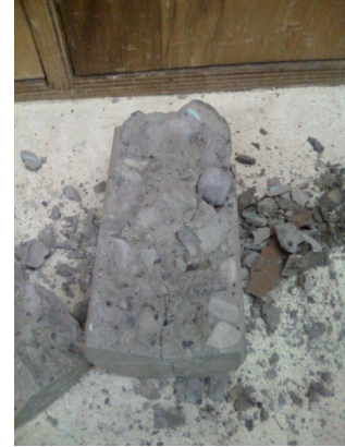
Foto 28. Resultado de compresion – cilindro 3
