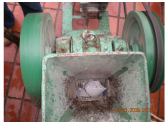
Foto 5. Pedazo de cilindro en la boquilla
