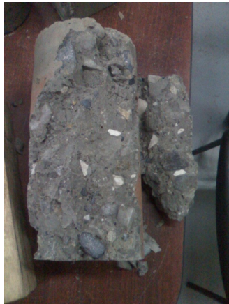
Foto 26. Resultado de compresion – cilindro 2
