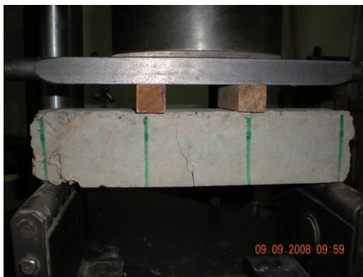
Foto 13. Resultado de flexion – vigueta 12
