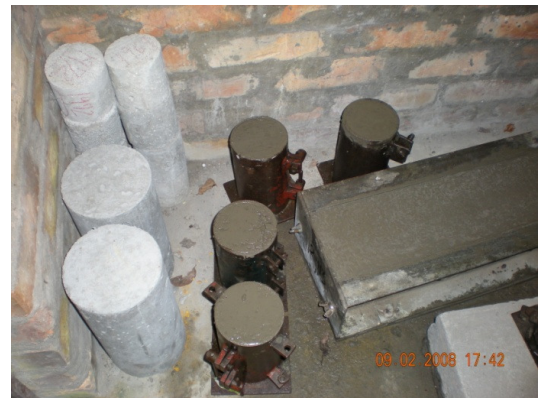
Foto 11. Viguetas y cilindros fraguando
