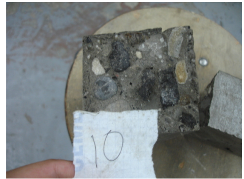
Foto 23. Resultado de flexion – vigueta 10
