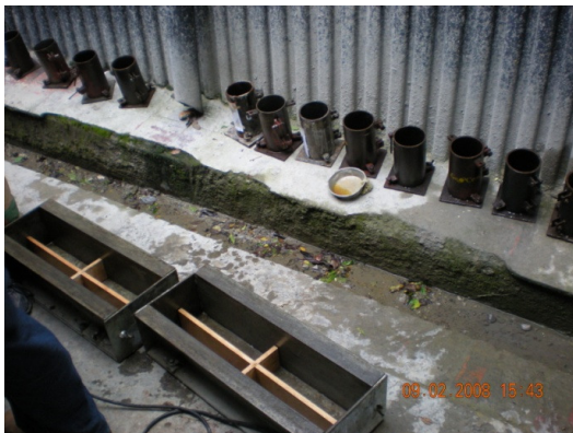
Foto 8. Moldes de las viguetas y cilindros
