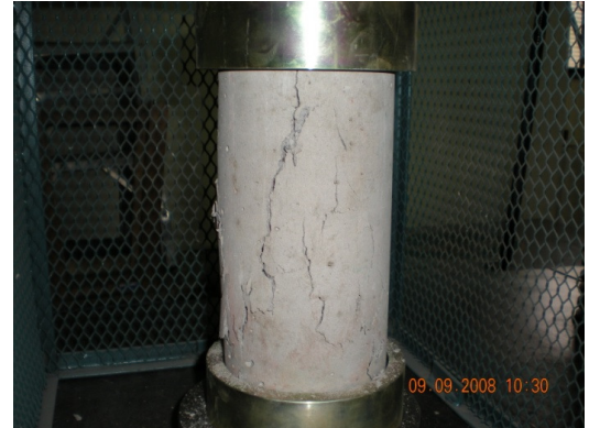
Foto 15. Resultado de compresion – cilindro 1
