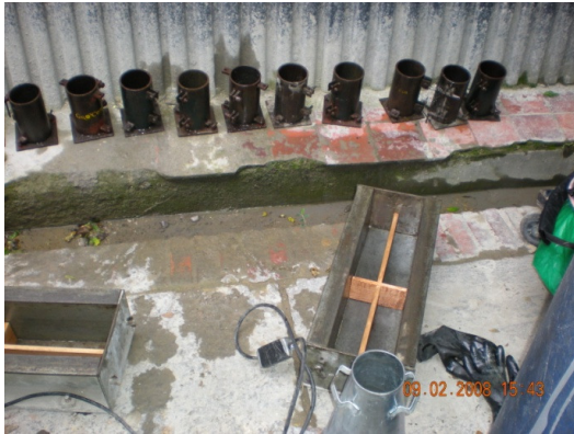
Foto 7. Moldes de las viguetas y cilindros
