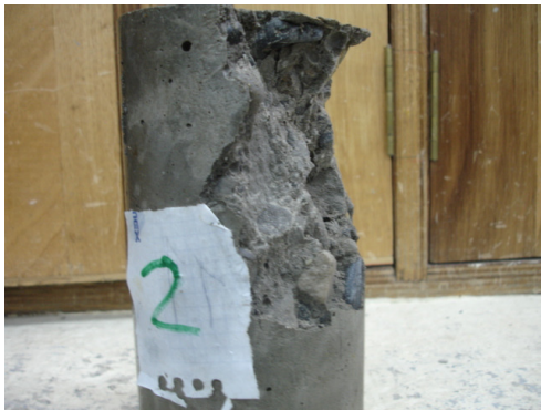
Foto 20. Resultado de compresion – cilindro 2
