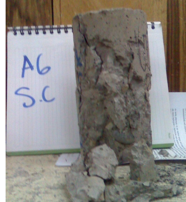
Foto 33. Resultado de compresion – cilindro A6
