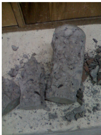
Foto 27. Resultado de compresion – cilindro 1
