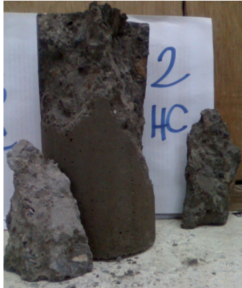
Foto 36. Resultado de compresion – cilindro 2
