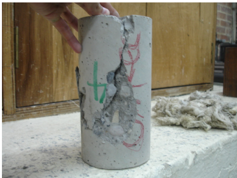
Foto 21. Resultado de compresion – cilindro 4
