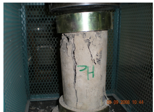
Foto 16. Resultado de compresion – cilindro 2
