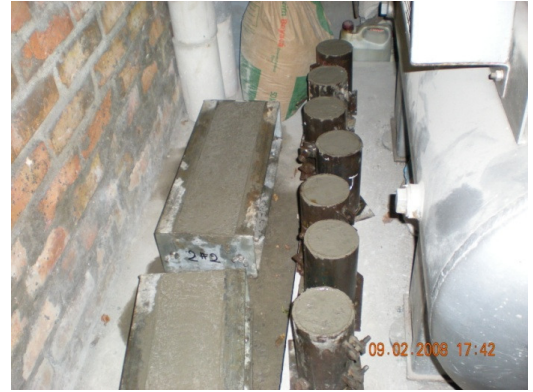
Foto 10. Viguetas y cilindros fundidos
