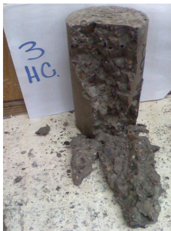
Foto 37. Resultado de compresion – cilindro 3
