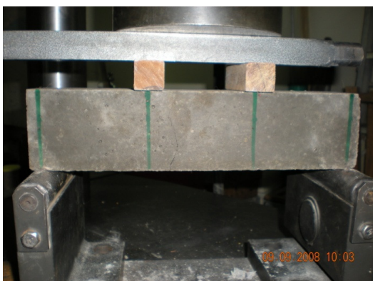
Foto 14. Antes del ensayo a flexion
