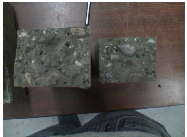
Foto 29. Resultado a flexión – vigueta 1
