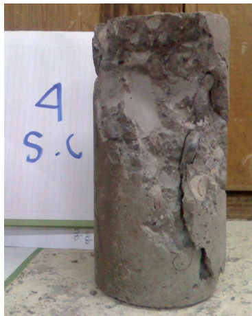
Foto 31. Resultado de compresion – cilindro 4
