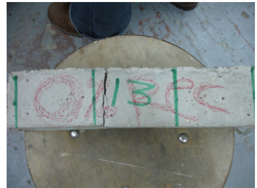
Foto 24. Resultado de flexion – vigueta 13
