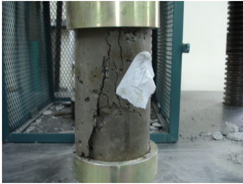
Foto 19. Resultado de compresion – cilindro 1
