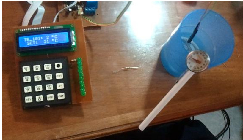
Imagen 3. Prueba de temperatura descendente con temperatura aproximada a 0 °C
