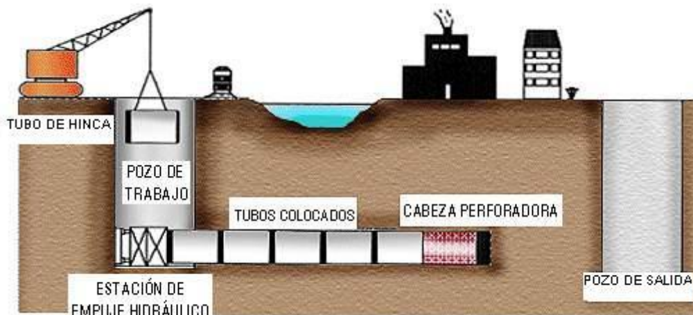
Imagen N°3: Auger Boring (Yepes, V, 2014).
