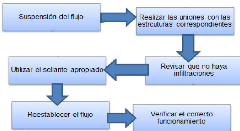
Imagen N°19: Diagrama de flujo proceso de conexión (Mahecha, 2013; Swarup, Niranjana, 2012)
