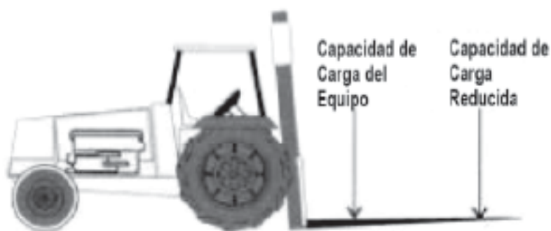
Imagen N°16: Montacargas para transporte de tuberías (Revinca, 2011).
