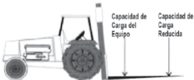
Imagen N°16: Montacargas para transporte de tuberías (Revinca, 2011).
