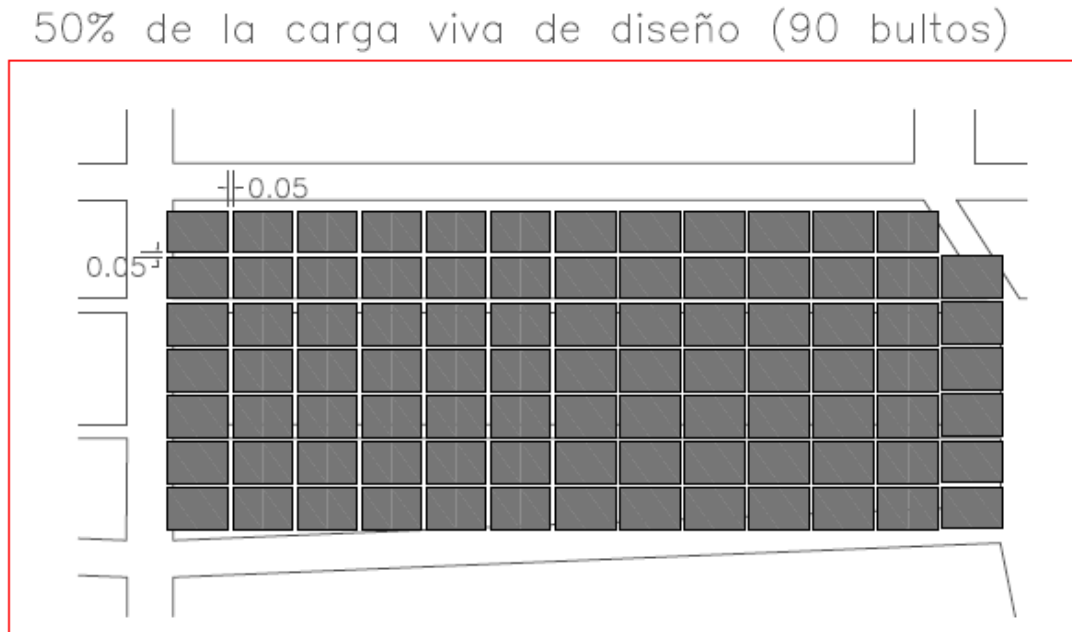
Ilustración 12.8: Ubicación de los bultos al 50% de la carga viva de diseño
