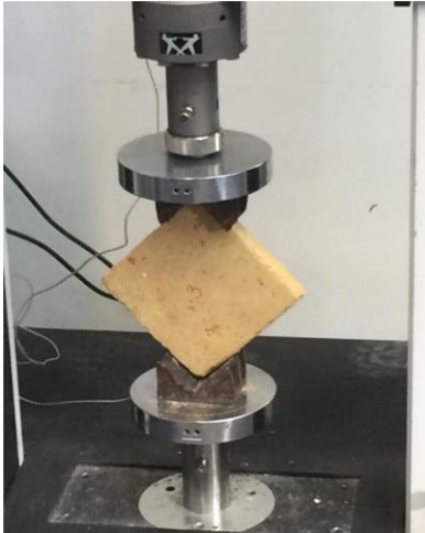
Figura 35 - Montaje del murete sin refuerzo
