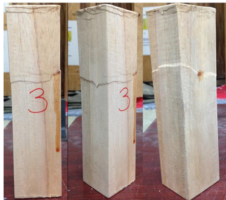
Figura 23 - Tipo de falla de la probeta 3
