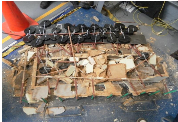
Figura 68 - Colapso total del modelo sin refuerzo
