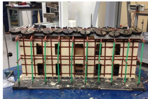
Figura 56 - Modelo reforzado con cargas antes del sismo
