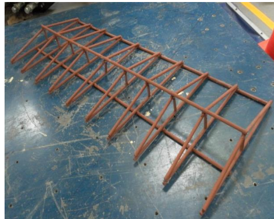
Figura 51 - Cubierta de la estructura
