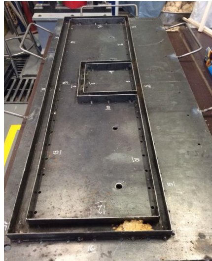
Figura 44 - Base metálica de la formaleta
