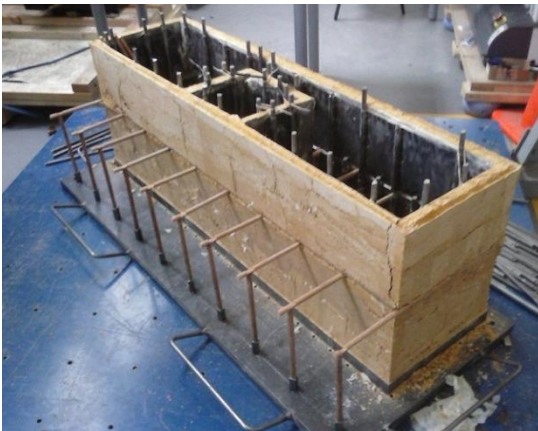
Figura 49 - Modelo sin refuerzo recién desencofrado
