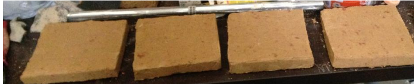
Figura 32 - Muretes recién desencofrados
