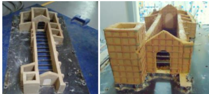
Figura 17 - Modelo de capilla doctrinera con y sin refuerzo (Ruiz et al., 2014)
