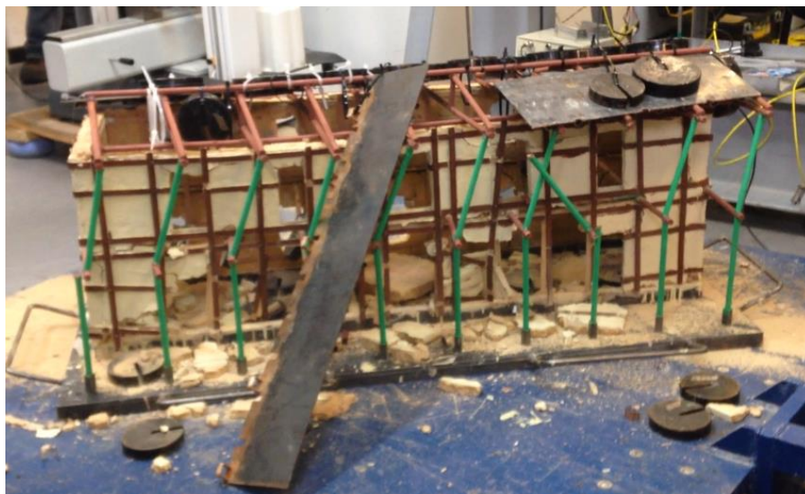
Figura 74 - Modelo reforzado luego de la aplicación de desplazamiento sinusoidales
