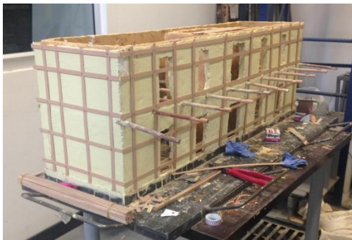
Figura 53 - Colocación de la madera de refuerzo
