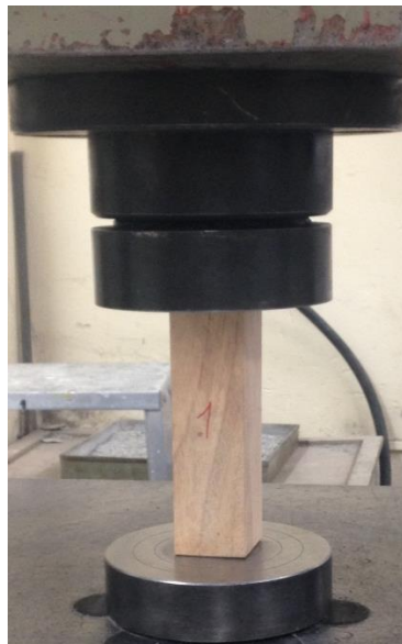
Figura 20 - Montaje de probetas a compresión sobre la máquina universal
