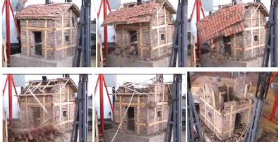
Figura 16 - Colapso del modelo en adobe con refuerzo de madera de confinamiento (Yamín et al., 2007).
