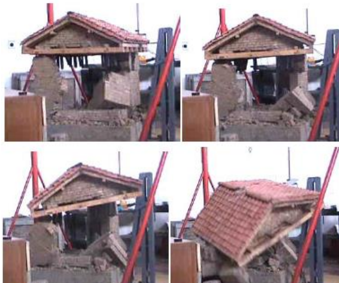
Figura 15 - Colapso de modelo en adobe sin refuerzo (Yamín et al., 2007)
