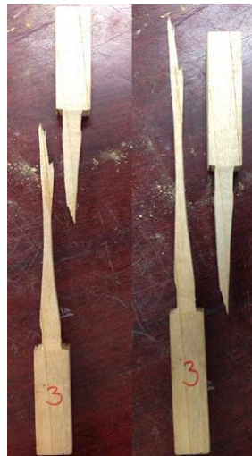
Figura 28 - Falla de la probeta 3 a tensión
