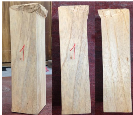
Figura 21 - Tipo de falla de la probeta 1
