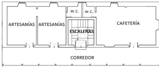
Figura 5 - Planta primer piso modificada (Uribe et al., 2013)
