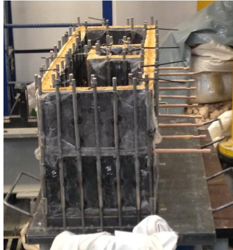
Figura 48 - Muros construidos del modelo sin refuerzo
