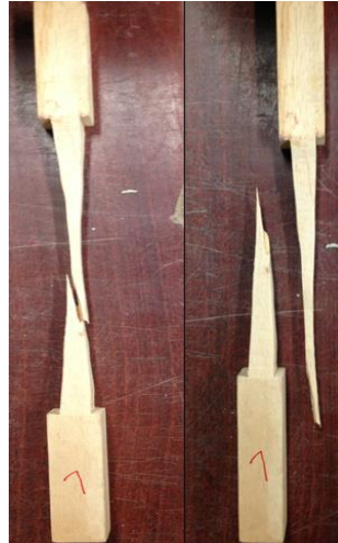
Figura 27 - Falla de la probeta 1 a tensión
