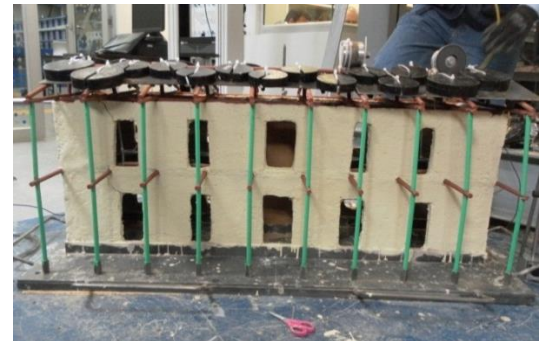
Figura 52 - Modelo sin refuerzo antes de la falla
