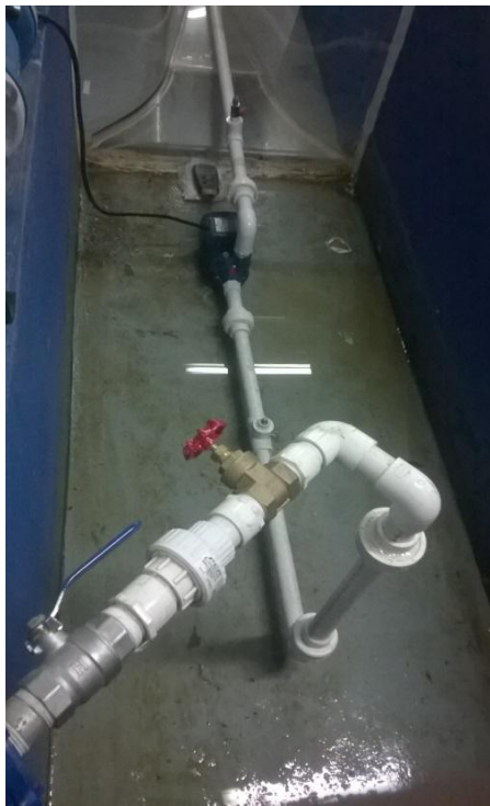
Ilustración 9a Montaje Hidráulico: Conexión Directa
