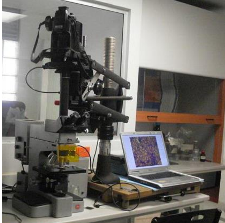
Figura 5.9. Microscopio óptico Ortoplan Leitz® de contraste de fase y sistema de adquisición de imágenes digitales (Instalaciones del centro de Microscopía Óptica PUJ)
