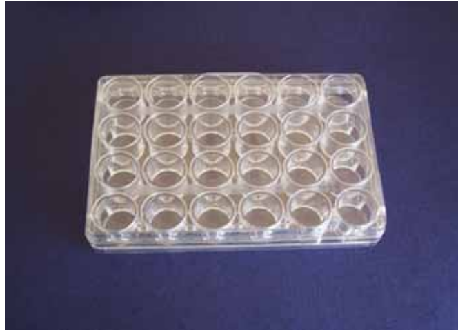
Figura 11. Caja de 24 pozos.
