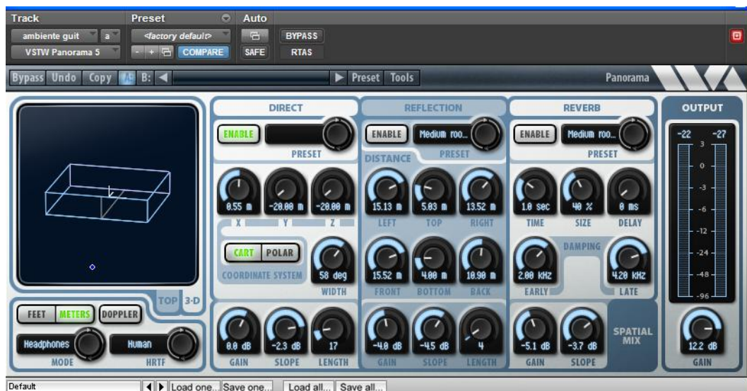
Figura 16 y 17: Posicionamiento de un instrumento por medio del plug in.
