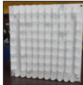
Figura. 51 base de foam board (cartón con espuma) y silicona maciza Fuente: propia
