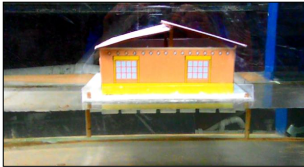
Figura 57. Momento de flotación del modelo sin guías Fuente: propia
