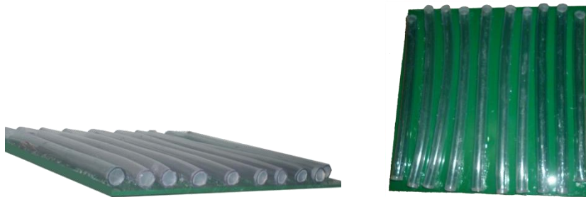
Figura 52. Base en acrílico con manguera con tapones Fuente: propia
