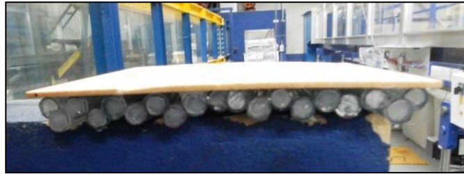
Figura 51. Base en balsa con manguera con tapones Fuente: propia
