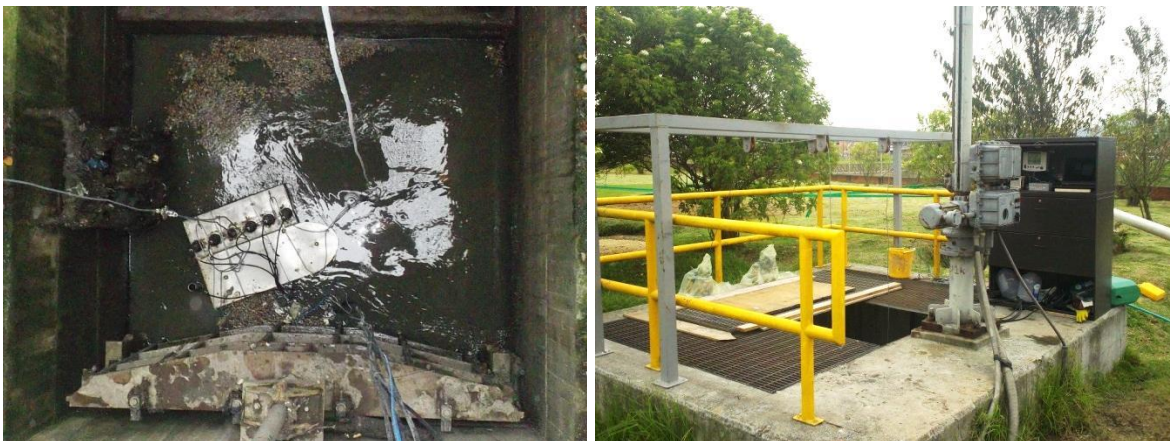
Figura 27- Bote y sondas de medición (Izq.) y dispositivos para control y almacenamiento de datos de las sondas de monitoreo (Der.) (Autor, 2012)
