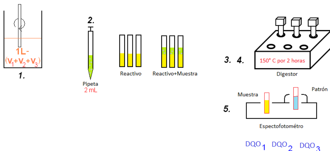
Figura 174- Principio de medición DQO por triplicado (adaptado de Lepot, 2012)
