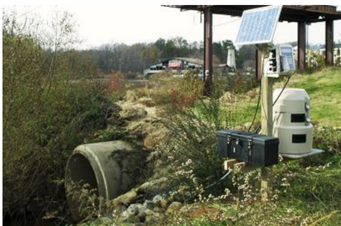
Figura 164- Estación de monitoreo de una red pluvial con muestreo automático en Greenville, Carolina del Sur-E.E.U.U. ( www.apwa.net )
