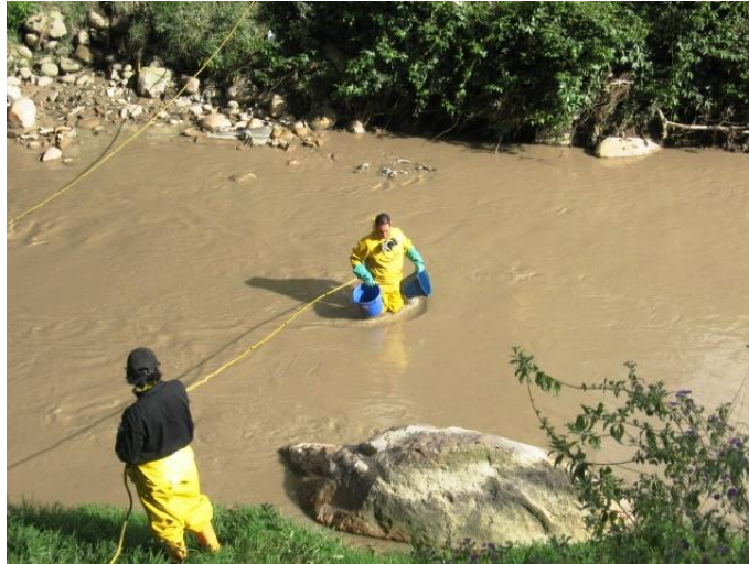
Figura 163- Toma de una muestra compuesta (isovolumétrica) en el punto Doña Juan del río Tunjuelo (RCHB-SDA, 2012)
