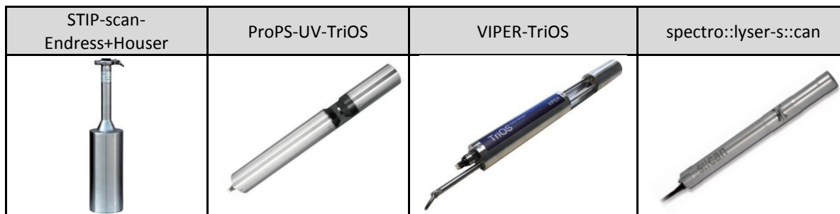
Figura 8- Sonda disponibles en mercado para la medición in situ del espectro UV-Visible
