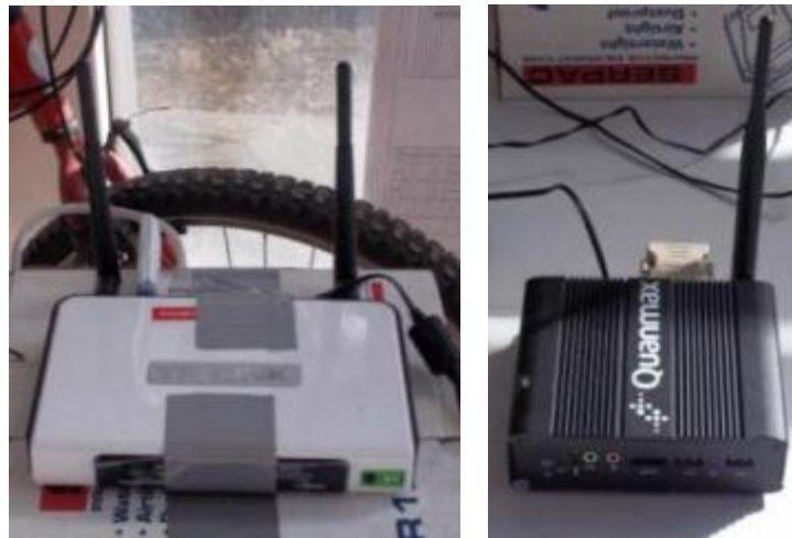
Figura 25. Router y computador industrial
