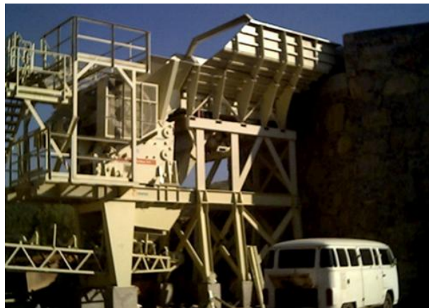
Figura 7. Sistema fijo de trituración. Fuente. Crushing and screening handbook METSO2011
