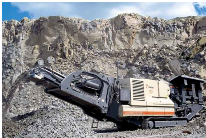
Figura 8. Sistema móvil de trituración. Fuente. Crushing and screening handbook METSO 2011
