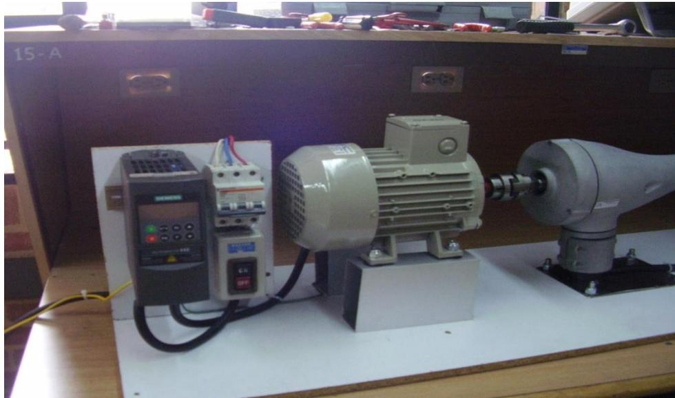
Posterior al montaje del generador, motor y variador de velocidad con su programa, se comenzó probando diferentes velocidades del motor para obtener mediciones de frecuencia del generador y calcular las revoluciones por minuto del aerogenerador, como también obtener las revoluciones por segundo y el número de polos del generador.
