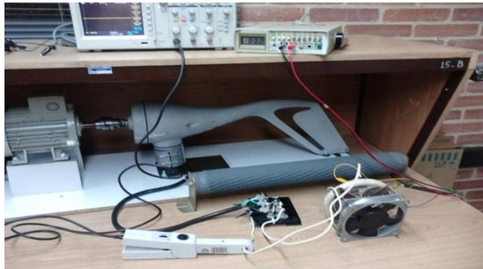
El procedimiento fue ir subiendo la frecuencia de giro del aerogenerador ARI-X hasta llegar a las 1800 RPM, se tomó nota del voltaje y la corriente en la carga de medio ohmio, para poder graficar estos valores.
