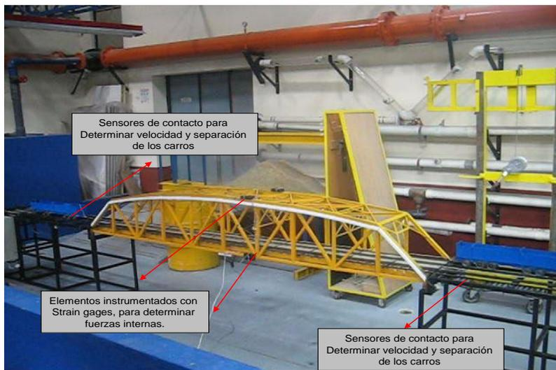
Figura 2-3 Prototipo a escala del puente Puerto Salgar, con su respectivo sistema de instrumentación
