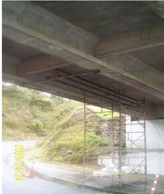
Figura 2-4 Instalación de los LVDT que permiten medir deformaciones verticales por el paso del tráfico sobre el puente
