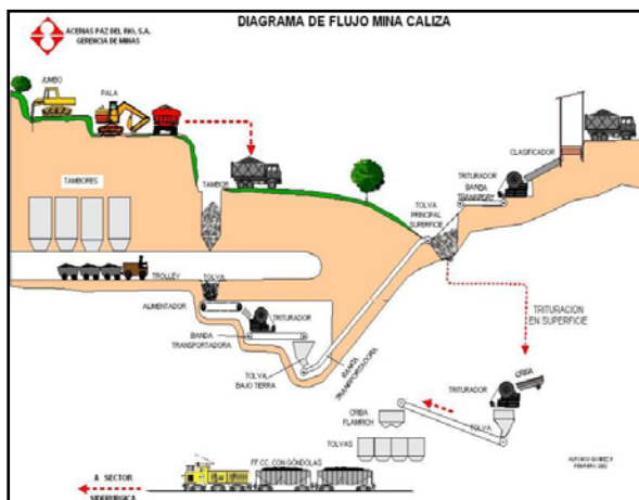
Gráfico 3. Diagrama de flujo mina de Caliza.
