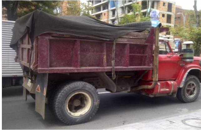
Fotografía: Volquetas de transporte de RCD sobredimensionando su capacidad de carga
