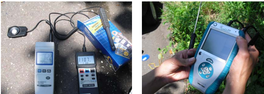
FIGURA 10. Medición de condiciones ambientales por medio de sensores de humedad relativa, luminosidad, pH de suelo, temperatura ambiental y de suelo. Fuente: Autor, 2010
