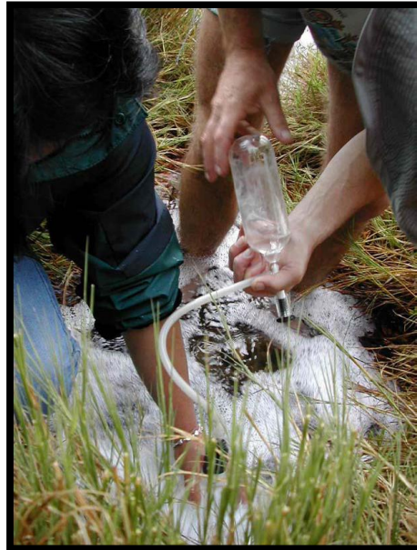
Figura 10. Medición de gases en el pozo principal de Salpa. La abundante espuma refleja una alta descarga de gas. Fuente: Alfaro, 2005.
