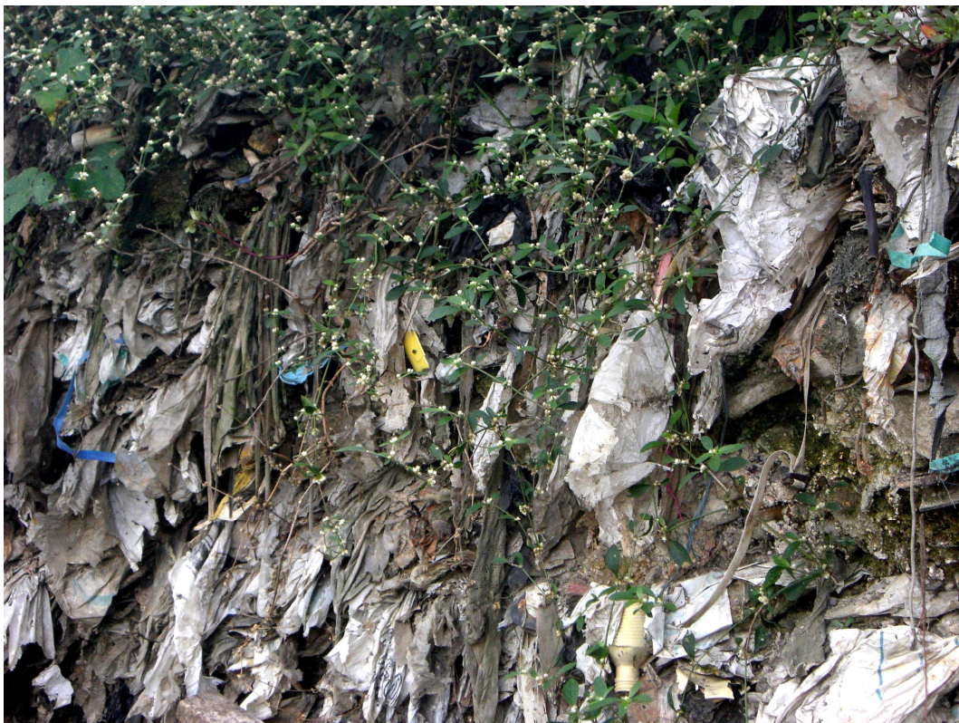
Figura 5: Corte representativo de la matriz de residuos semidegradados en el cerro de basuras de Moravia
