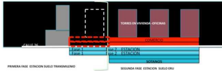
Grafica 12. Vista desde la Av. Caracas. En gris los edificios permanentes ubicados sobre la Caracas. En azul, los sótanos. Se destinan los niveles 1 y 2 para la Estación Central en sus dos fases. Fuente: DTS Estación Central 2012.
