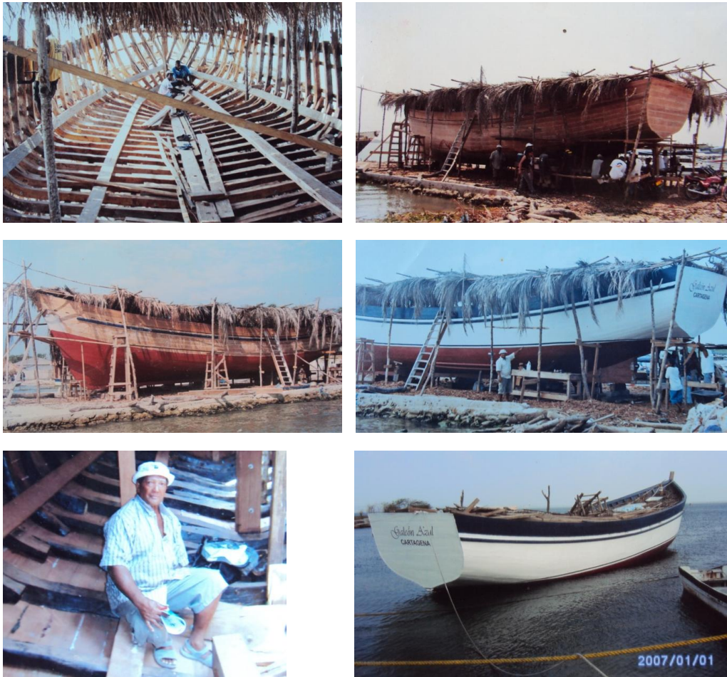
Descripción: proceso constructivo de la embarcación “El Galeón Azul” y la enramada construida para la protección contra el sol, Fuente: Fotografía tomada por el maestro carpintero de ribera Osvaldo Torres – “El Nenito”. 2007. Imagen No. 15 – Proceso constructivo del barco “Galeón Azul”
