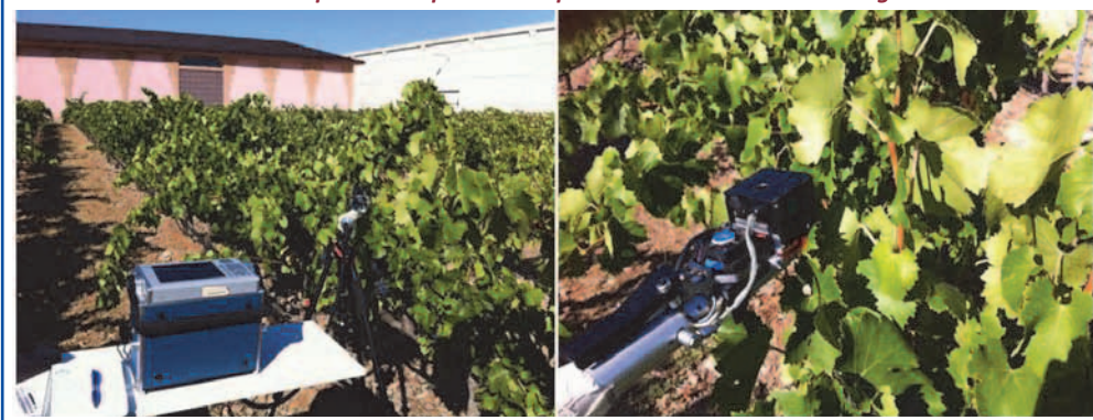
Detalle del dispositivo experimental para medir el intercambio de gases.
