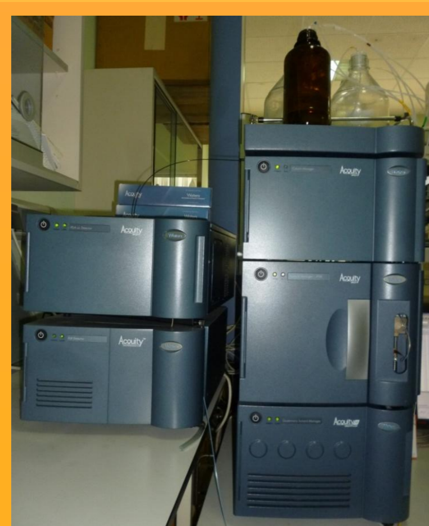
Fig. 3. Procedimiento de extracción e identificación de capsicinoides a partir de frutos de pimiento 'Malagueta'. (A) Método de extracción de capsicinoides mediante ultrasonidos; (B) Equipo UPLC-UV utilizado para la identificación de capsicinoides.
