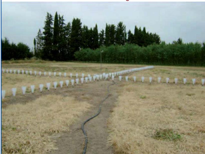
esta distribución es circular e igual en todas las direcciones alrededor del aspersor. La evolución de la descarga de agua del aspersor (mm/h) en función de la distancia al aspersor se denomina curva radial del aspersor.
