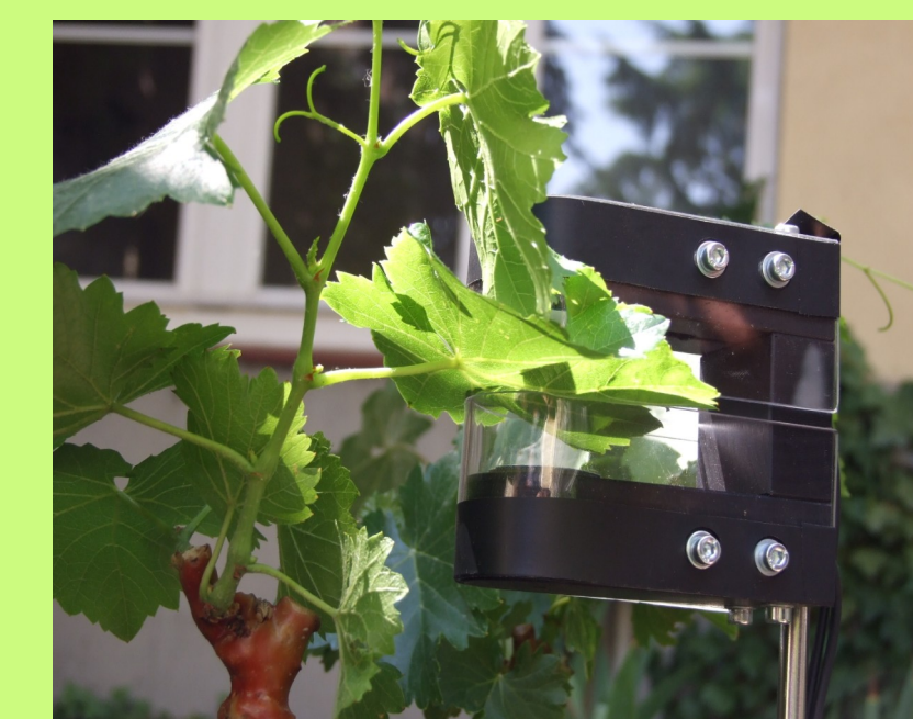
Medición del contenido de agua en plantas por ultrasonidos
