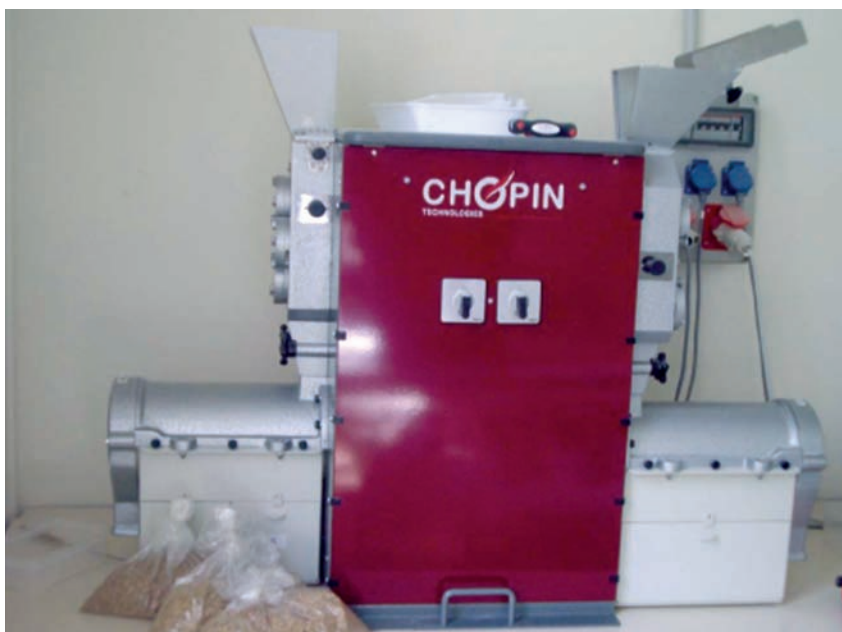
Figura 4: Molino Chopin CD2 para la molienda experimental de trigo duro.
