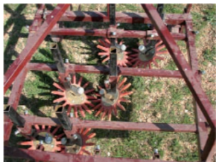
Figura 1 b.- Escardador de dedos instalado en un bastidor para desherbar tres filas de cultivo de azafrán. Se incluyen rejas de cultivador para las interlíneas.
