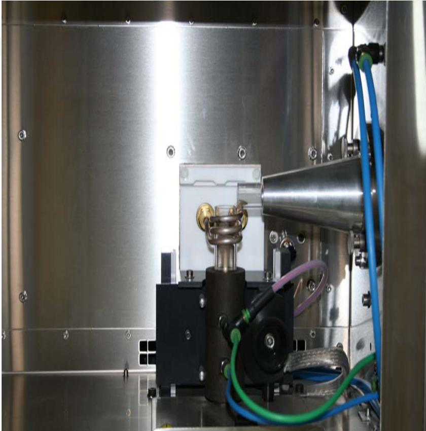
Un flujo de Ar circula a través de un tubo de cristal, dentro de un solenoide. Se crea un campo magnético inductivo dentro del tubo que sujeta los electrones producidos y circulan a través de eje del tubo describiendo circuitos anulares. Colisionan, calientan e ionizan otros átomos del gas.
