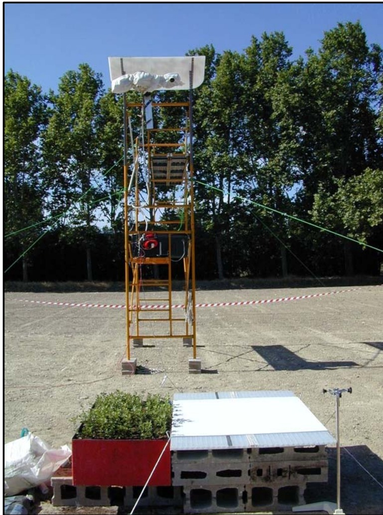
Figura 5.4. Fotografía del dispositivo experimental utilizado para la medida a distancia y en continuo del PRI. Se puede observar la colocación del sensor de PRI, el dosel de brinzales de Q. coccifera y el panel de referencia.
