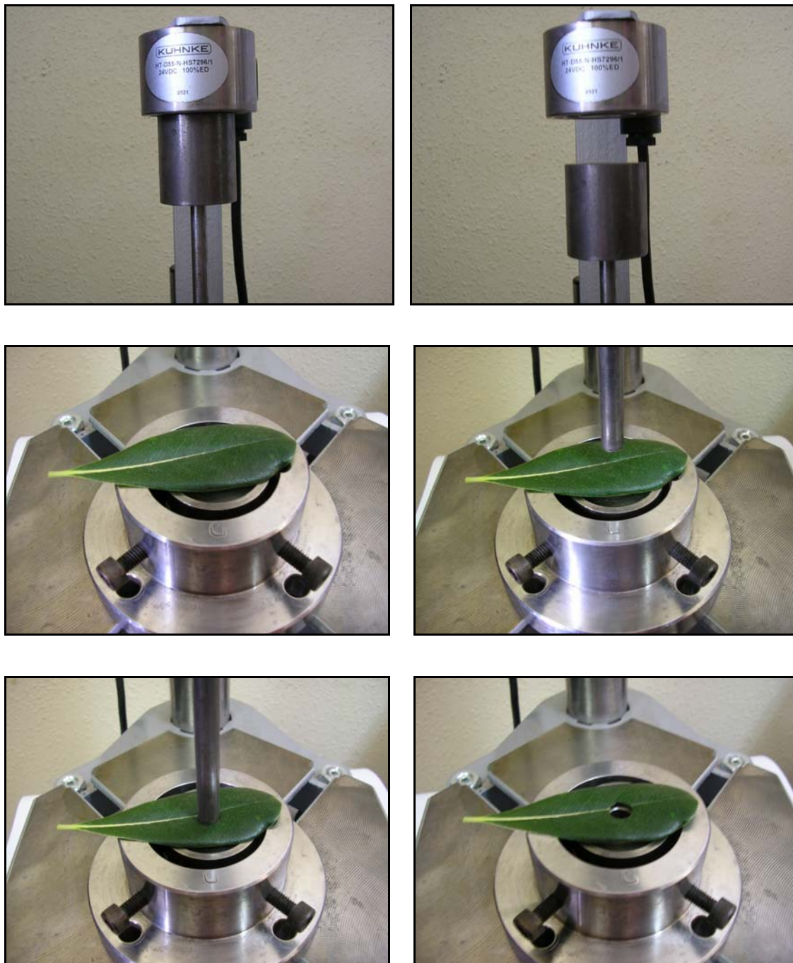
Figura 6.3. Secuencia de eventos que se suceden tras la liberación del electroimán y que tienen como resultado la obtención de un disco de hoja que se congela inmediatamente en nitrógeno líquido.
