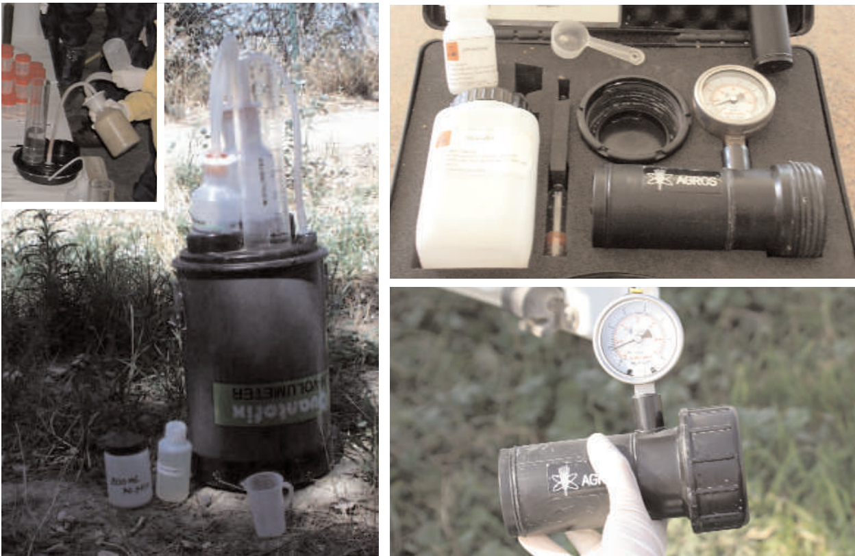
Figura 3. Vista del aparato Quantifix® (izquierda) y Agros® (derecha) utilizados en las determinaciones de las muestras de purín
