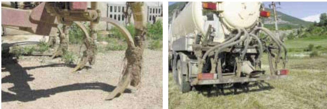
**Figura 5. Aplicación de purín mediante enterrador con disco**
