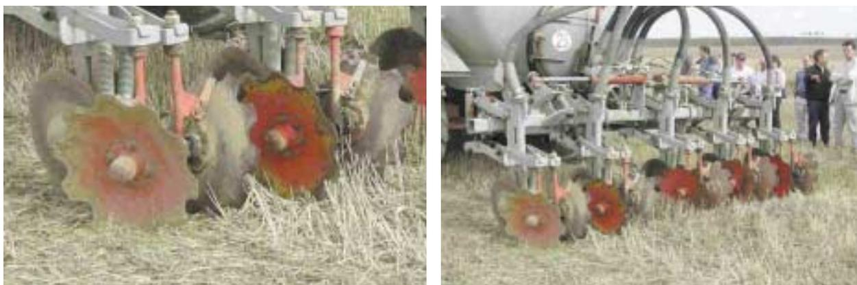
**Figura 6. Aplicación de purín mediante inyección**
