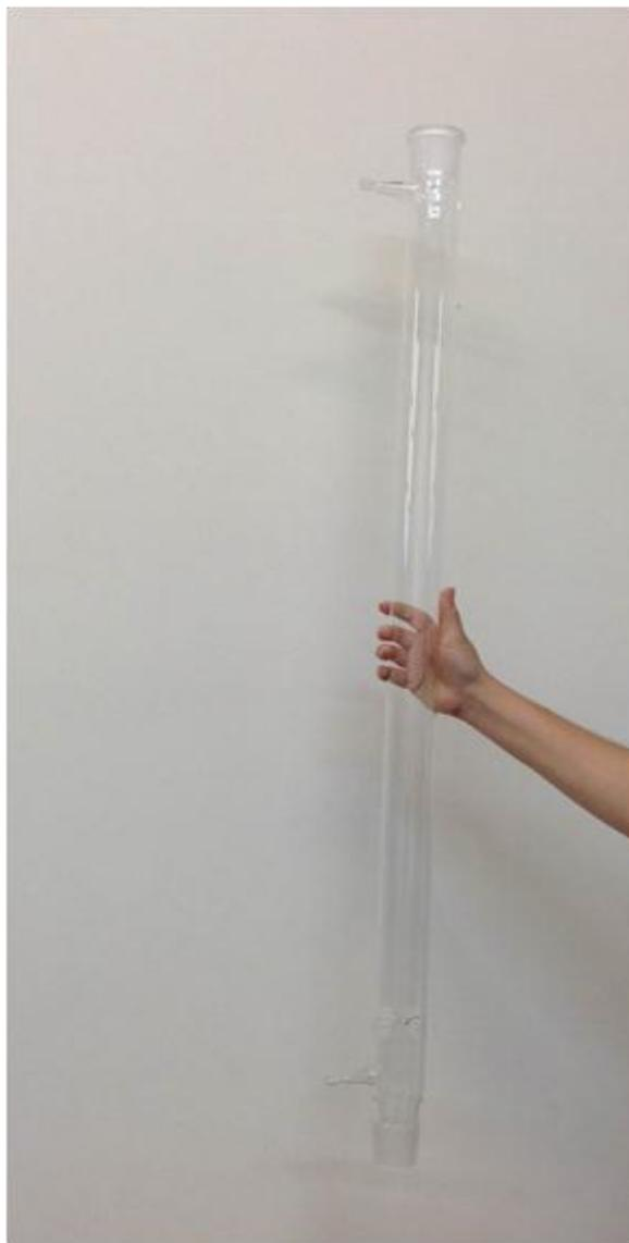
**Figura 17.** Accesorios para entrada y salida de fase pesada.
