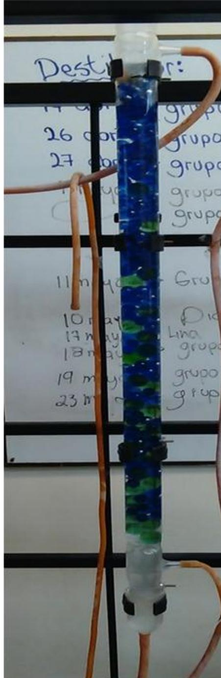
7. Se enciende la bomba que contiene el alimento, hasta que formen las dos fases y empieza el proceso de extracción. El flujo para esta bomba es el máximo a 3,573 kg/h
