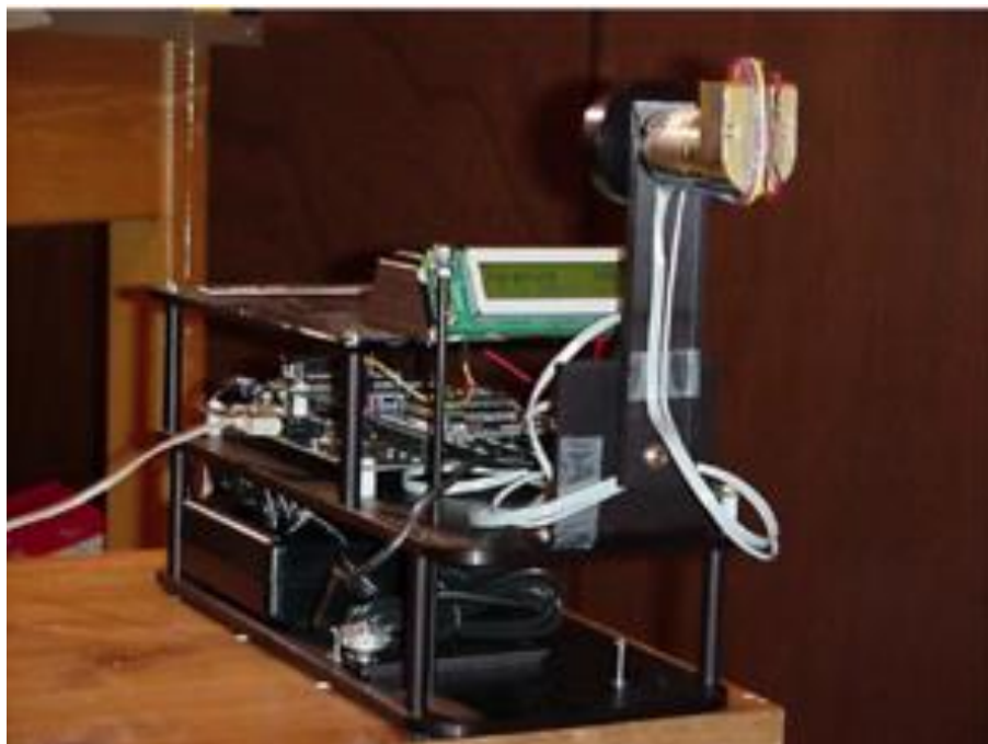
Figura 1. Péndulo con rueda de reacción.
