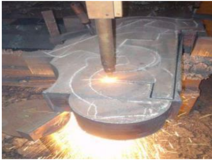
Figura 11. Corte de metal por oxicorte. (16)
