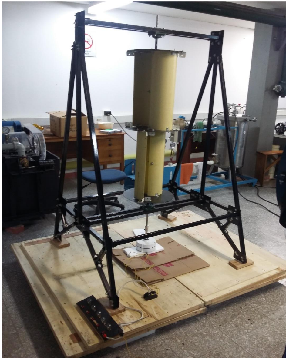
Figura 14. Montaje del aerogenerador eólico savonius. (Autor)
