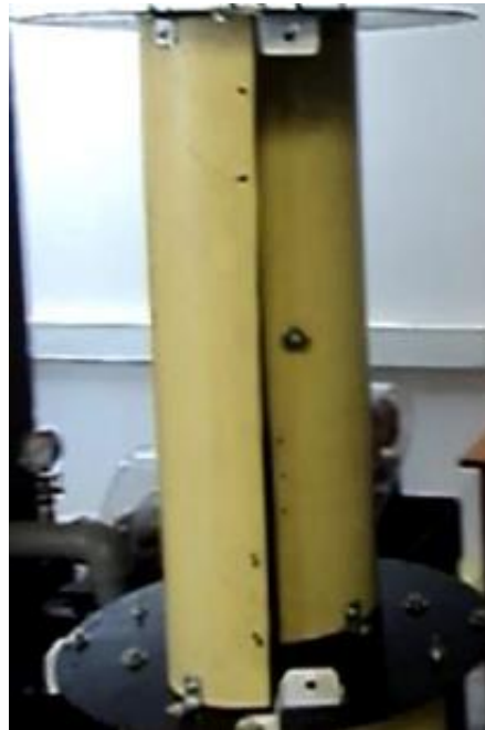
Figura 8. Perfil de aspas en tubo de pvc (Autor)
