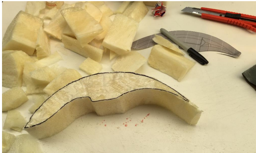
Figura 3.11. Bloque de espuma de poliuretano cortado con bisturí
