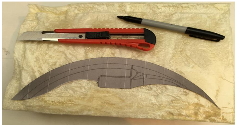
Figura 3.10. Bloque de espuma de poliuretano con la plantilla a trazar
