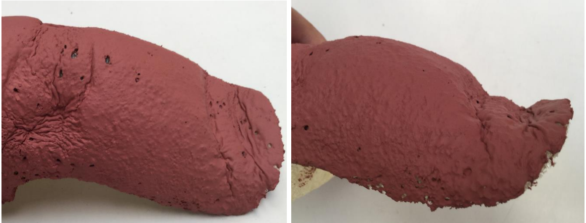
Figura 3.15. Modelo con deformación por efecto del exceso de thinner
