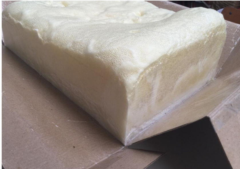
Figura 3.9. Bloque de espuma de poliuretano desmoldado
