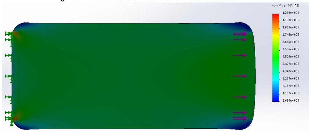
Figura del análisis de esfuerzos en el modelo fotoelastico con la ayuda de herramienta computacional (Solidworks)
