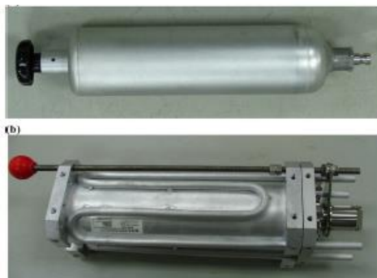
Ilustración 16: Canister solo y con sistema de calentamiento
