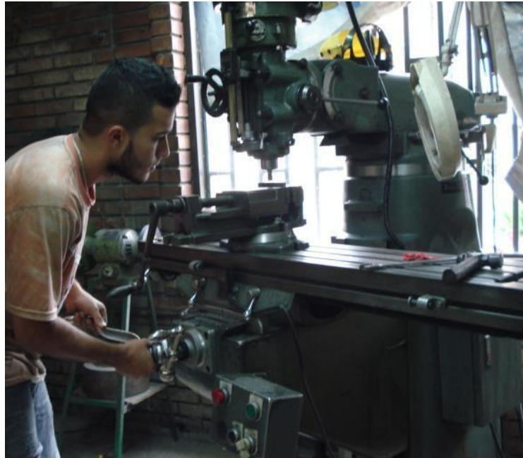
Ilustración 28. Mecanizado platina de sujeción.
