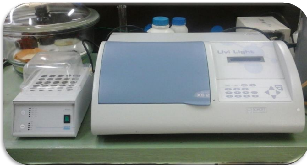
Ilustración 6 Equipos empleados en la determinación de la DQO.
