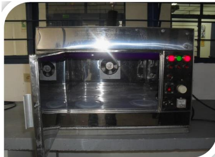
Ilustración 4 Reactor tipo batch con lámpara UV.
