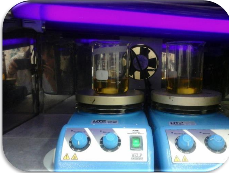
Ilustración 5 Montaje de degradación en un reactor tipo batch.
