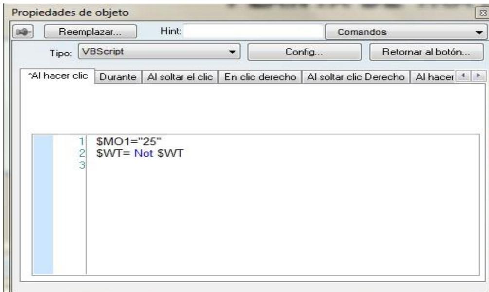
**FIGURA 35. Ejemplo trama de envío de datos desde el SCADA**
