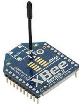
**FIGURA 21. Módulo Xbee serie 2**
