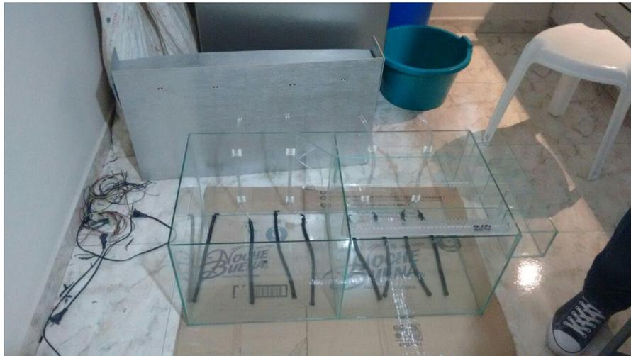
**FOTOGRAFIA 8.** Instalación tubería aireadores
