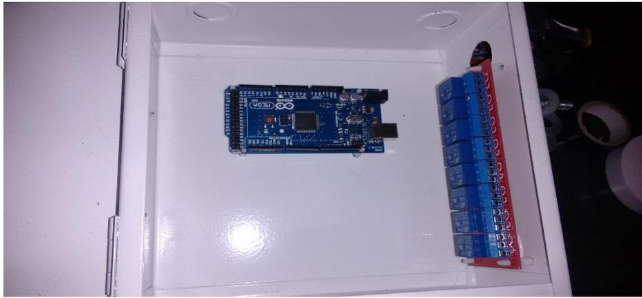
**FOTOGRAFIA 16. Instalación módulo de relés**
