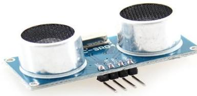
**FIGURA 9.** Sensor Ultrasonido
