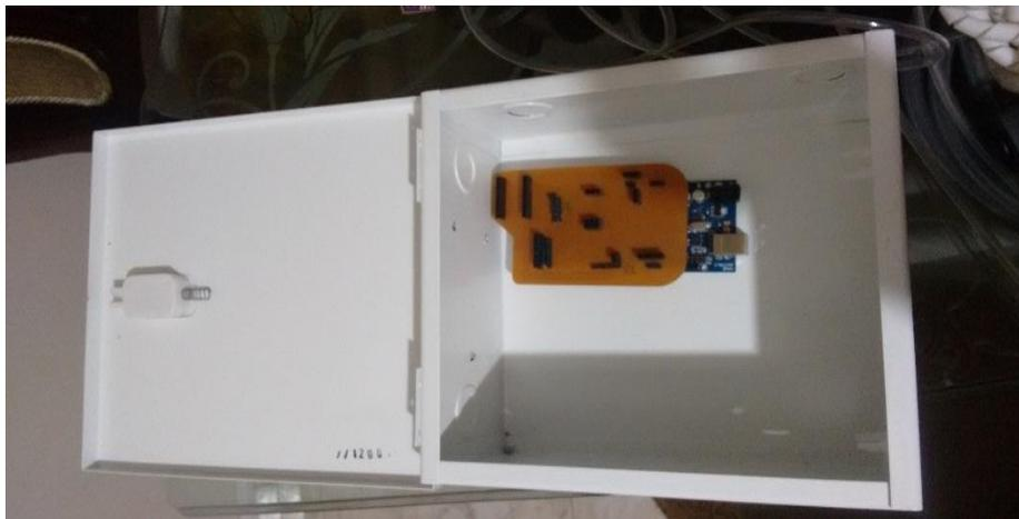
**FOTOGRAFIA 15. Instalación Arduino al cubículo de la unidad central de control.**
