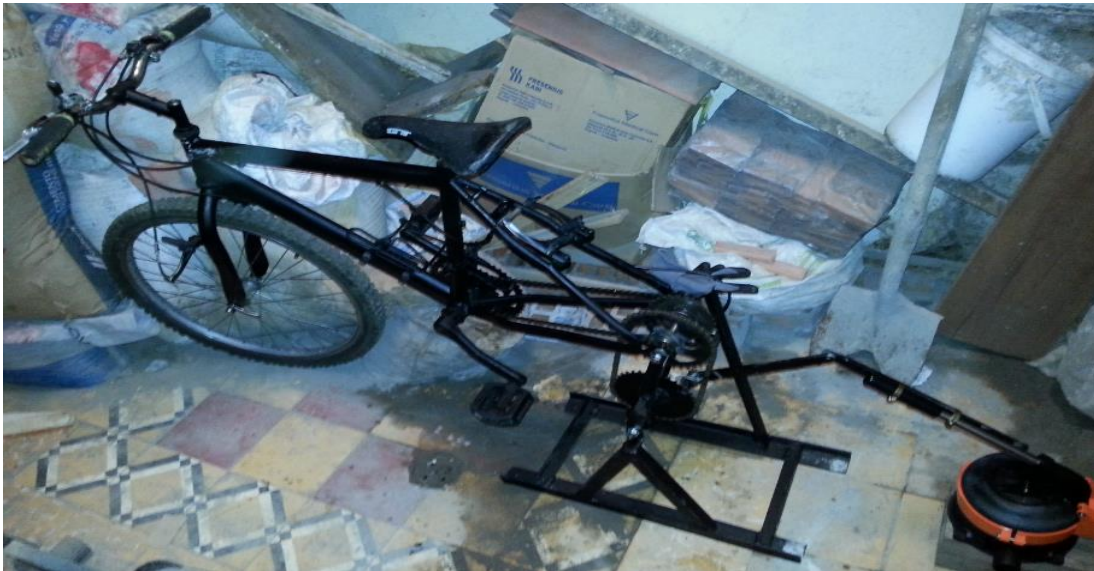
Figura 29. Sistema de bombeo por pedal (mecánico)
