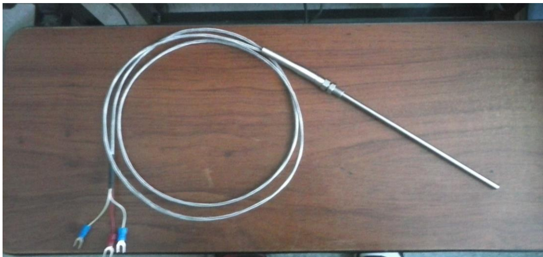
Figura 11 RTD PT 100 usada en el proyecto
