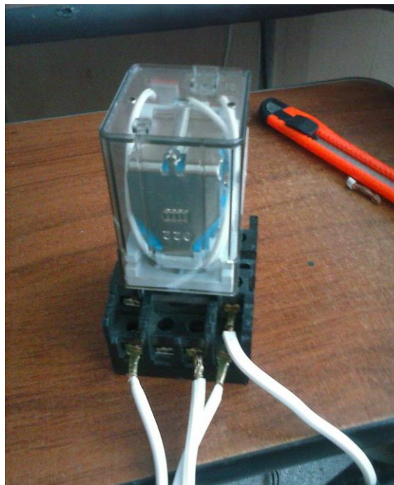
Figura 22. conexión del relé
