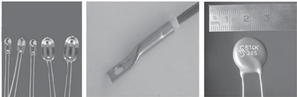
Figura 7 Fotos de termistores y dimensión aproximada.
