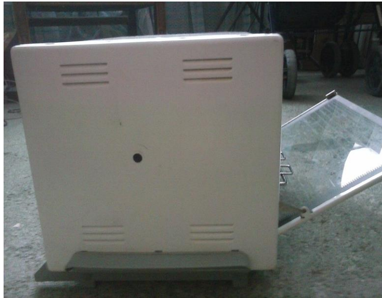
Figura 23 Perforación del horno
