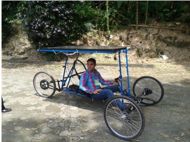
El vehículo presentaba dificultades en su movilización debido a que el motor limitado en potencia no cumplía con una adecuada movilidad en el área urbana en cuanto a los requerimientos en pendientes. El vehículo no contaba con un buen sistema de dirección que garantizará el buen funcionamiento y estabilidad del mismo, debido a que el sistema implementado no se realizó acorde con la geometría del vehículo y los limitantes de espacio generaban problemas de funcionamiento y un buen desempeño.
