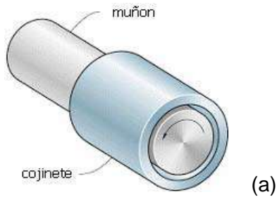
Ilustración 3. (a) Superficies rodantes concordantes, (b) superficies rodantes no concordantes
