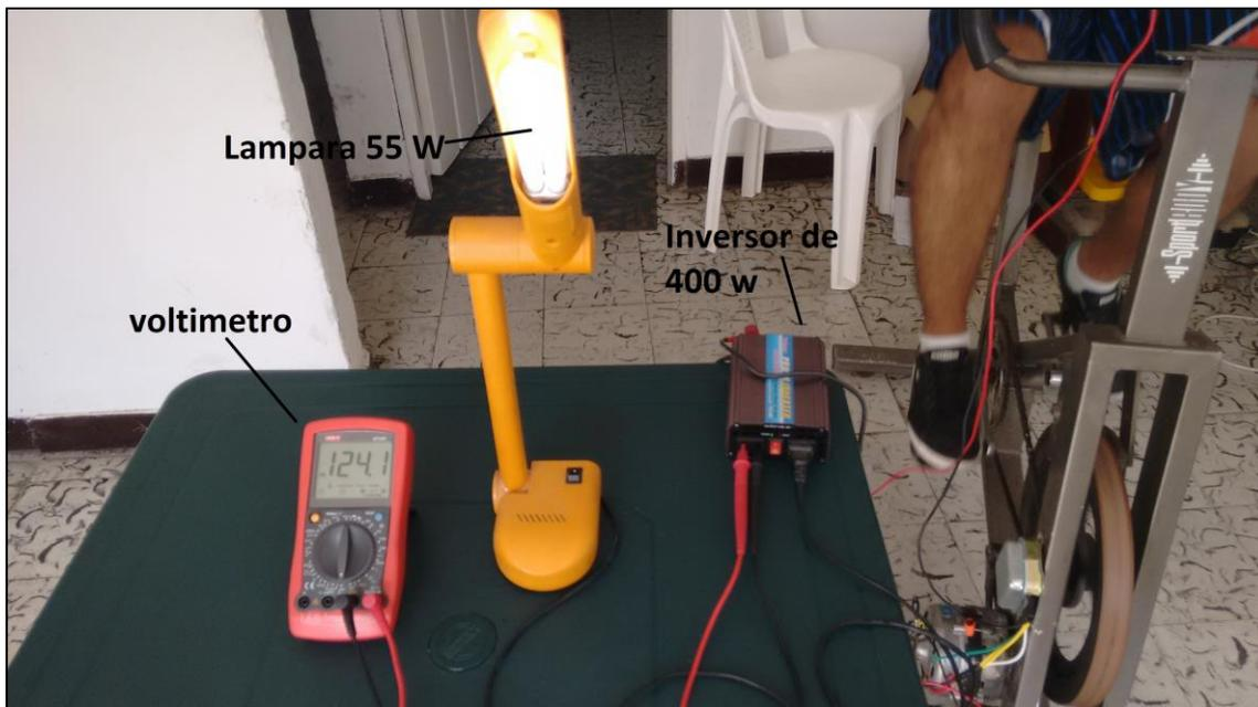
Ilustración 22. Prueba del sistema sometido a cargas eléctricas. Disponible en: Fuente propia.
