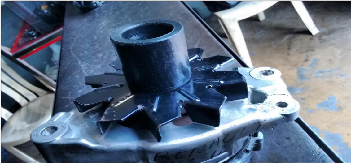
Ilustración 4. Acople en el eje del alternador. Disponible en: Fuente propia.
