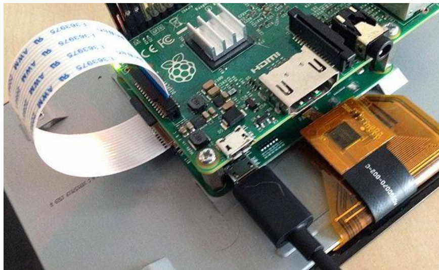
Figura 35. Conexión pantalla y Raspberry Pi
