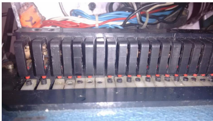
Figura 14. Distribución y muestra de desgaste de los switches
