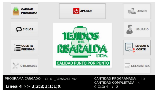
Figura 32. Pantalla principal en funcionamiento con un programa cargado
