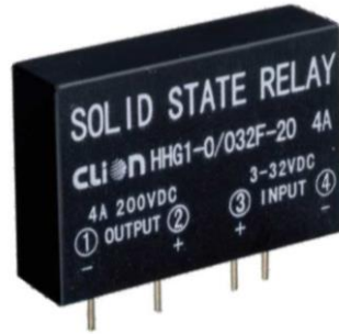
Figura 6. Relé de estado sólido (SSR) / HHG1-0/032F-20
