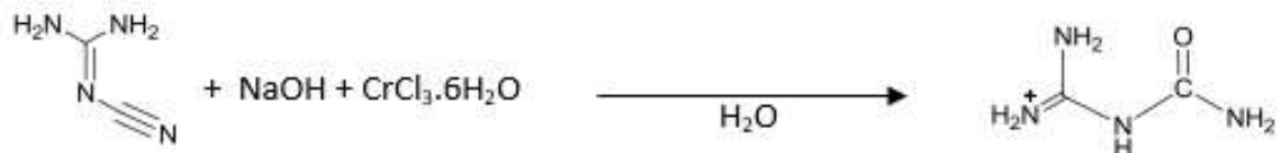
Esquema 9. Reacción de formación de la sal cuaternaria
