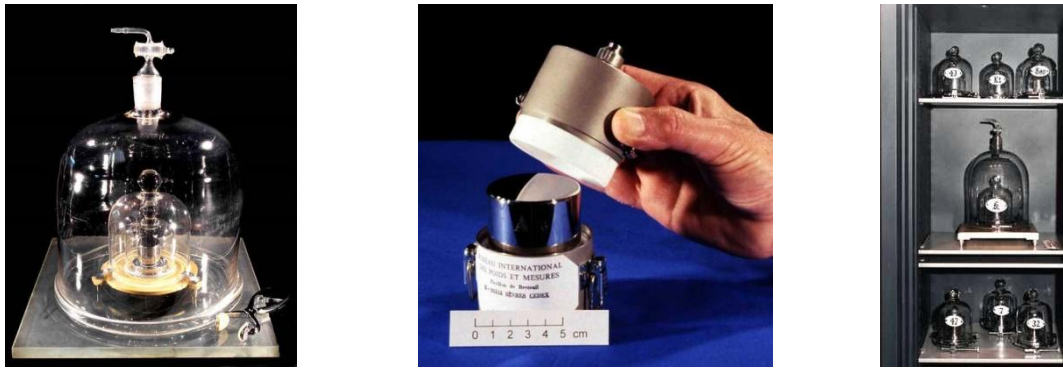
Figura 1. 2 Prototipos internacionales del kilogramo en la BIPM, Francia.
