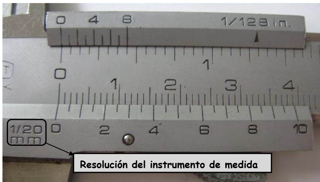
Figura 4.2 Resolución del calibrador.
