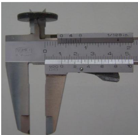
Figuras 4.4 Imágenes que muestran cómo utilizar el calibrador para mediciones internas y externas de una pieza
