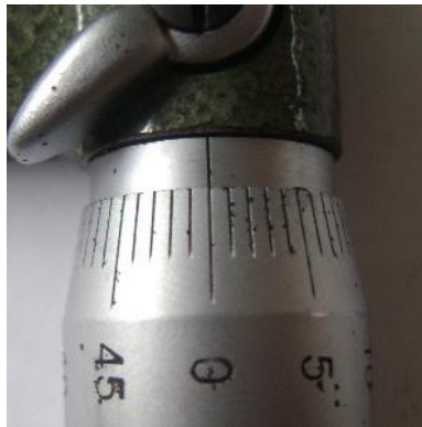
Figura 4.7 Ajuste del cero para el tornillo micrométrico.
