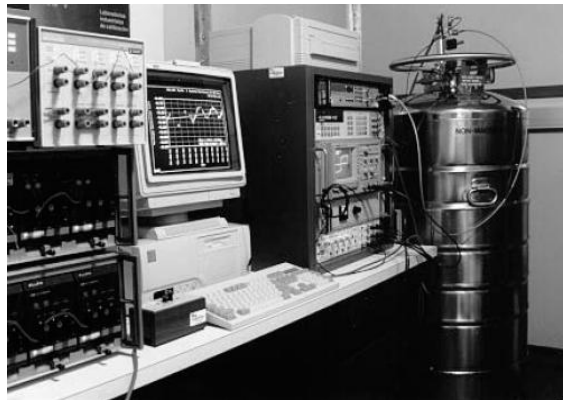
Figura 1. 4 Efecto Josephson. Laboratorio Patrón de Tensión, CENAM, México.
