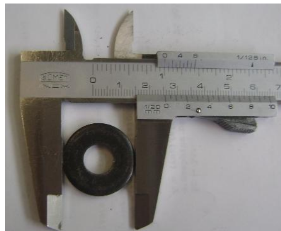
Figuras 4.4 Imágenes que muestran cómo utilizar el calibrador para mediciones internas y externas de una pieza
