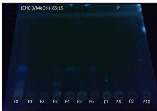
Figura 4.4 Perfiles cromatográficos de las fracciones F 1 -F 10 del extracto butanol de la corteza interna de Tabebuia rosea en cloroformo-metanol (85:15) a longitud de onda (366nm)
